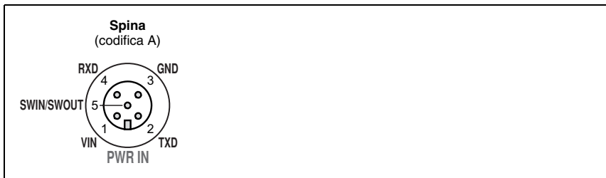
Figura 3.3: BPS 8 - segnali applicati al connettore M12 PWR IN
