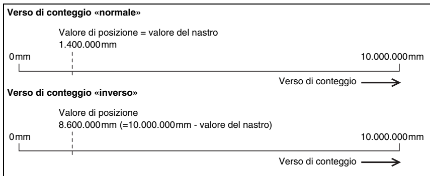
Figura 8.9: Verso di conteggio per il calcolo della posizione
