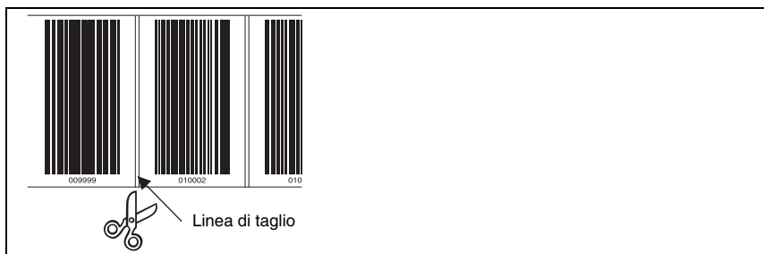
Figura 6.3: Linea di taglio del nastro di codici a barre
