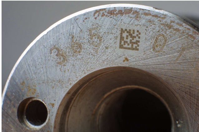
Data Matrix Code direktmarkiert (gelasert)
