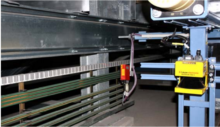
Bild 4: Der Sicherheits-Laserscanner ROTOSCAN RS4 sichert den Bereich in der Lagergasse zuverlässig ab, z.B. falls Instandhaltungsarbeiten ausgeführt werden müssen. Das Barcode Positioniersystem BPS 34 positioniert das RGB.
