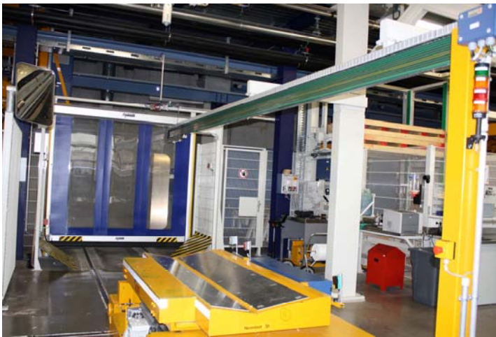
Bild 5: Auch Verteilerwagen, die nach dem Mutter-Tochter-Prinzip funktionieren, sind mit Sensoren von Leuze electronic ausgestattet.
