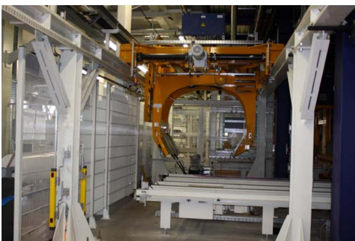
Bild 6: ROBUST Mehrstrahl-Sicherheits-Lichtschranken sichern Zugänge zu Gefahrbereichen am Transportportal ab.
