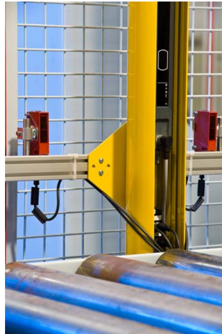
Bild 3. Detailaufnahme der UDC Gerätesäule mit Muting-Transceiver (in der Säule) und montiertem MMS Muting-Montagesystem inklusive vorverkabelten Muting-Sensoren
