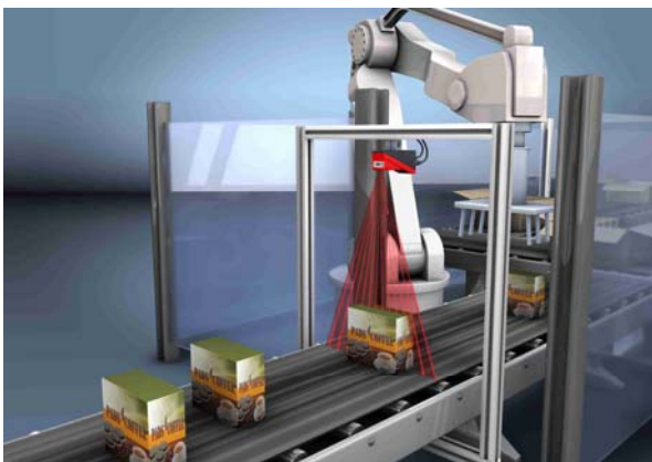
Bild 6. In dieser Greifersteuerung können mit dem LPS Sensor die 3D-Daten der Teile auf dem bewegten Förderband gewonnen werden.
