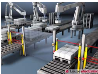
Zugangssicherung mit MLD Mehrstrahl-Sicherheits-Lichtschranken in einer Applikation mit partiellem Muting
