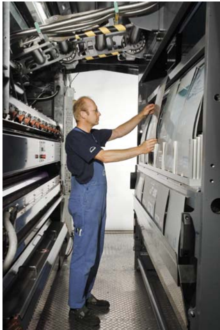
Bild 4: Manuelle Bestückung des Druckplattenspeichers vor dem Starten des APL-Systems
