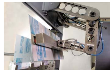
Bild 2: Mechanisch stabiles Automatic Plate Loading (APL-) System für das Handling der Druckplatten
