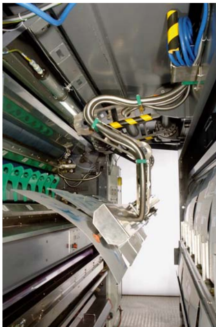
Bild 6: Zuführen der Druckplatten zum Zylinder (links) mit dem APL-System
