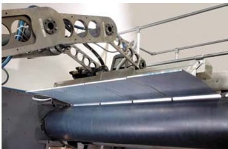
Bild 3: Aufziehen der Druckplatten mit dem APL-System
