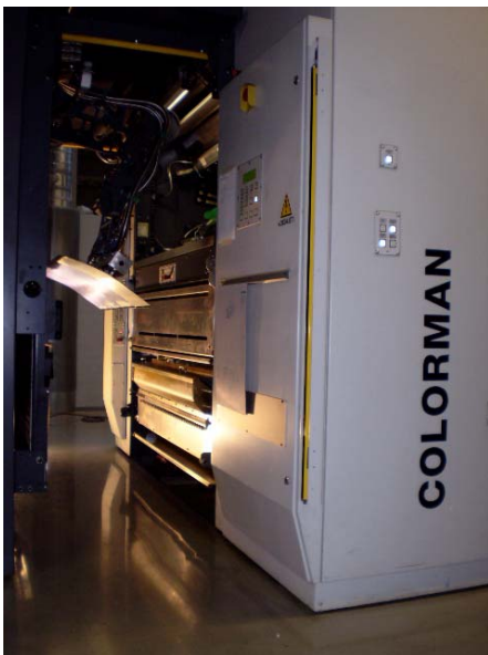
Bild 1: Sicherheits-Lichtvorhänge als Zugangssicherung bei einem vollautomatischen System für die Zuführung von Druckplatten
