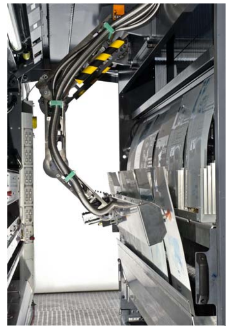
Bild 5: Entnahme der Druckplatten aus dem Druckplattenspeicher
