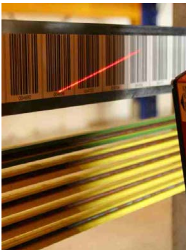
Bild 3. Der Lesekopf des BPS 34 liest immer mehrere Codierungen auf dem Codeband gleichzeitig (Quelle: LTW Intralogistics GmbH)
