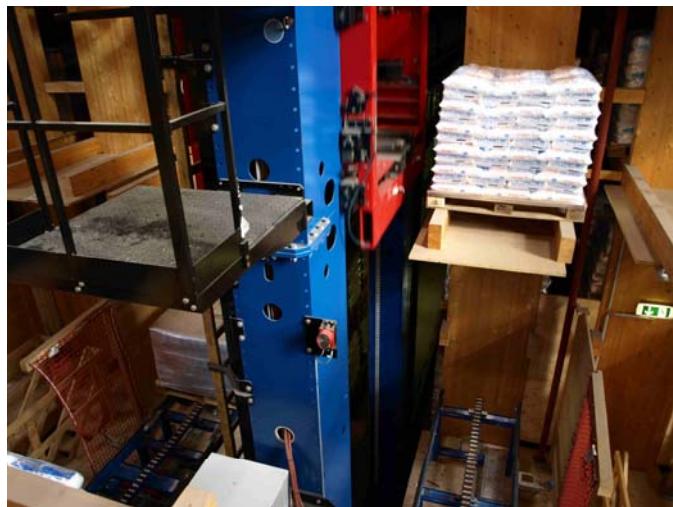
Bild 4. Datenübertragungslichtschranken DDLS 200 an den Regalbediengeräten ermöglichen die kontaktlose und verschleißfreie optische Kommunikation.
