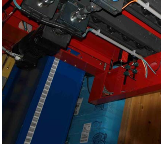
Bild 2. Auf dem Kunststoffband des BPS 34 sind die Absolutdistanzen codiert. Hier an der Vertikalachse eines Regalbediengerätes.
