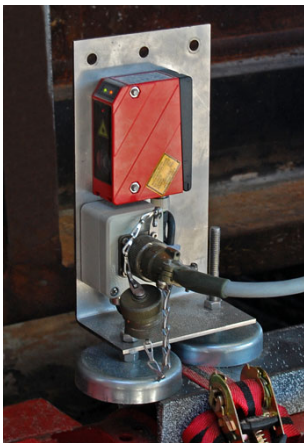
Bild 5. Die Montageplatte mit dem Sensor wird mit Magnet angebracht und ausgerichtet (Quelle: Syrinx Industrial Electronics, www.syrinx.nl)
