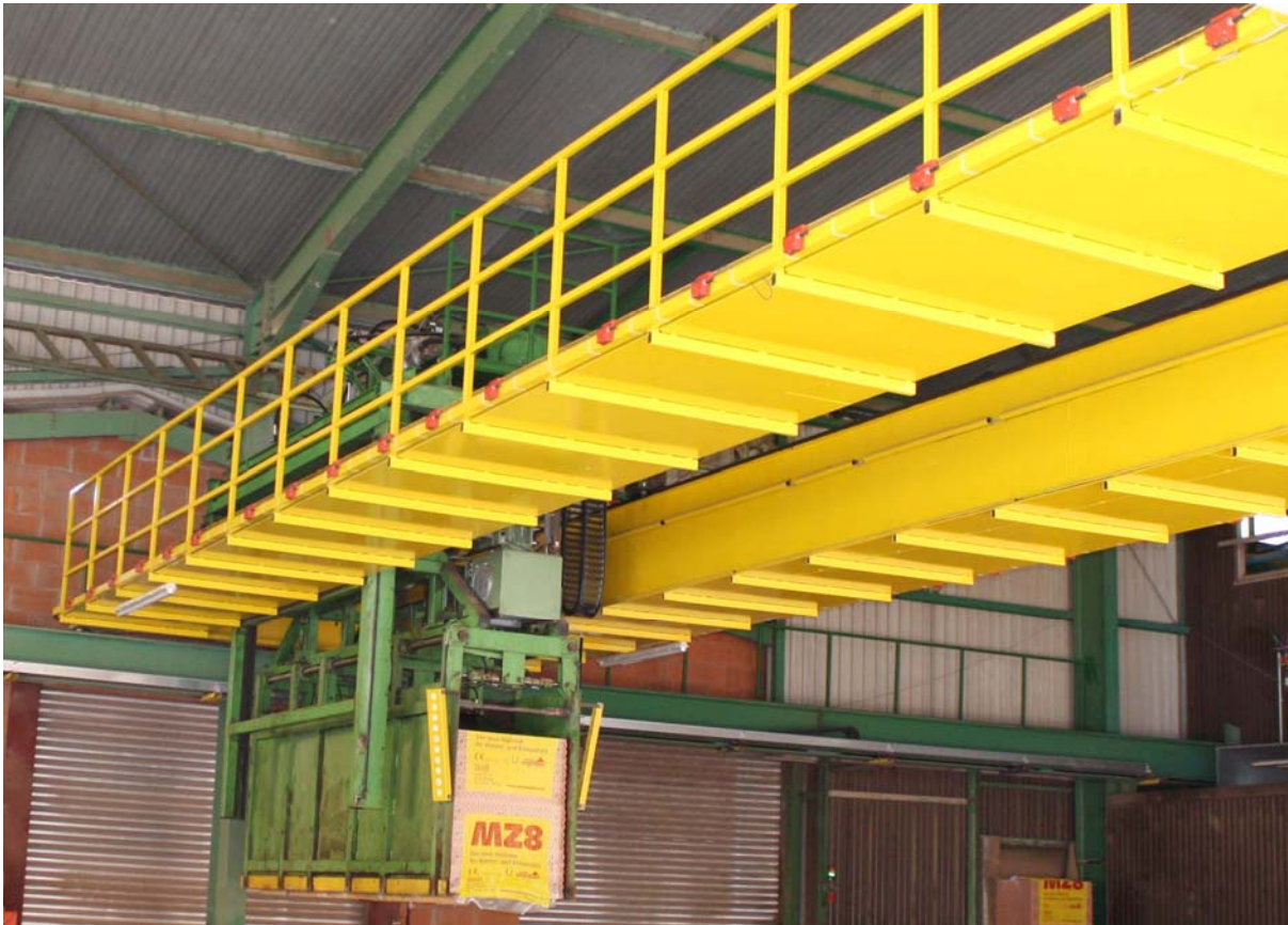
Reflexions-Lichttaster an der Traverse des Portalkrans überwachen die Rangierfläche von oben, um freie Abstellflächen zu finden.
