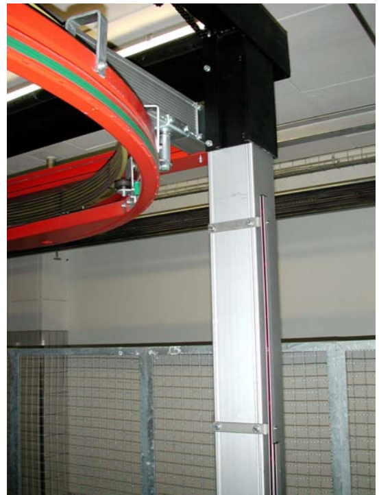
Montageposition des VARIO-Lichtgitters zur Erfassung von 7 \mu -starken Folien
